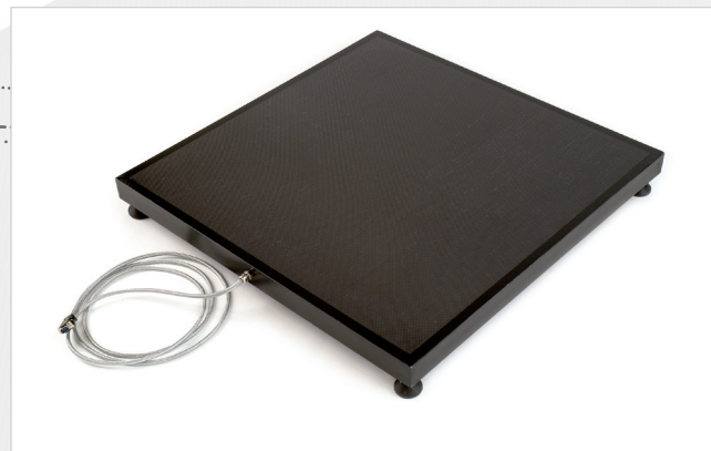
Piattaforma di pesatura Air serie GM 800mm x 800mm portata fino a 1500 Kg altezza 76 mm peso 14 Kg
